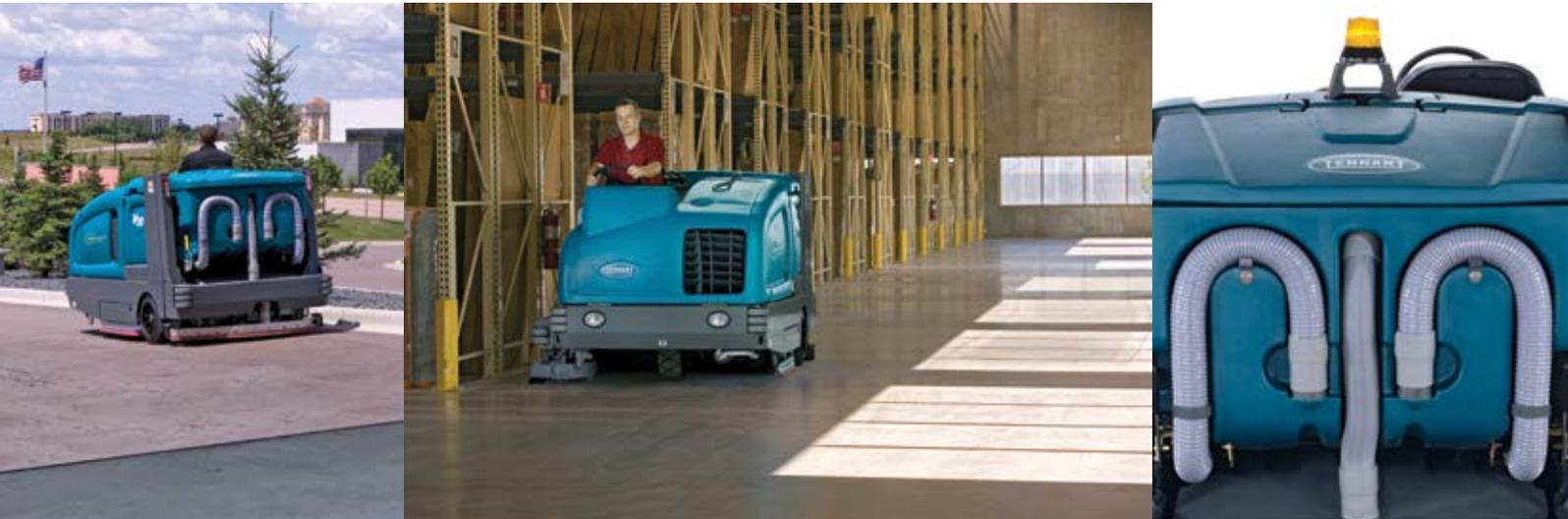
La barredora-restregadora completamente integrada M30 está diseñada para una limpieza industrial confiable y permite restregar, barrer o hacer las dos cosas al mismo tiempo.
