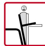
Control de velocidad de inclinación delantera del mástil
