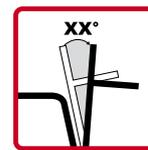
Control del ángulo de inclinación delantera del mástil
