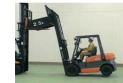
El riesgo de un vuelco hacia adelante aumenta proporcionalmente cuando se eleva la carga y el mástil se inclina hacia adelante (véase la imagen de la izquierda).
