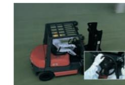
Toyota SAS hace que la perilla de la dirección vuelva siempre a la posición inicial después de un giro (a las "8 en punto" cuando se conduce en línea recta). Así se reduce el estrés del conductor aumentando su eficacia y seguridad en el lugar de trabajo.
